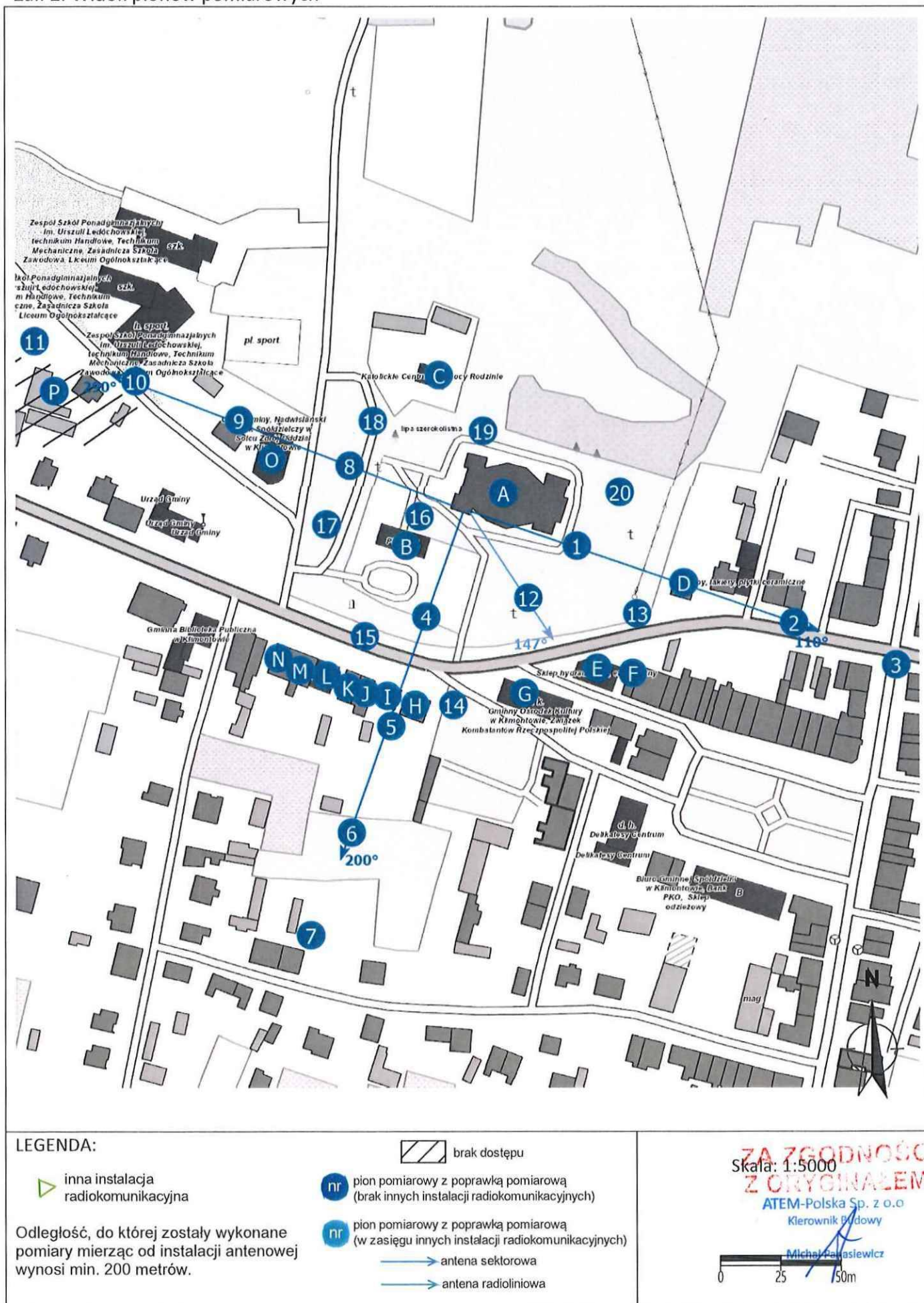
Załącznik 2. Widok pionów pomiarowych
